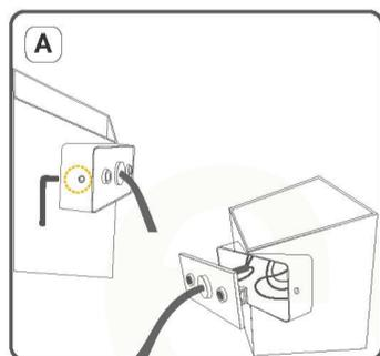
Retire los tornillos de la parte trasera de la luminaria para desmontar la base.
